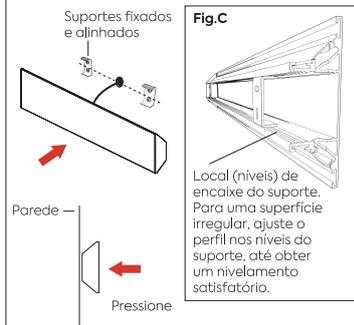
Local (níveis) de encaixe do suporte. Para uma superfície irregular, ajuste o perfil nos níveis do suporte, até obter um nivelamento satisfatório.
